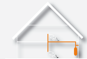
1 1/2-PLANS HUS EXEMPEL PÅ INSTALLATION I NYTT HUS, RÖRLEDNING I BJÄLKLAG OCH VÄGGAR
